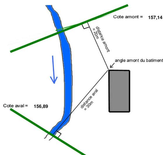
$$\text{Cote de la crue de référence} = \text{Cote amont} - \frac{(\text{Cote amont} - \text{Cote aval})}{(\text{Distance amont} + \text{Distance aval})} \times \text{Distance amont}$$
